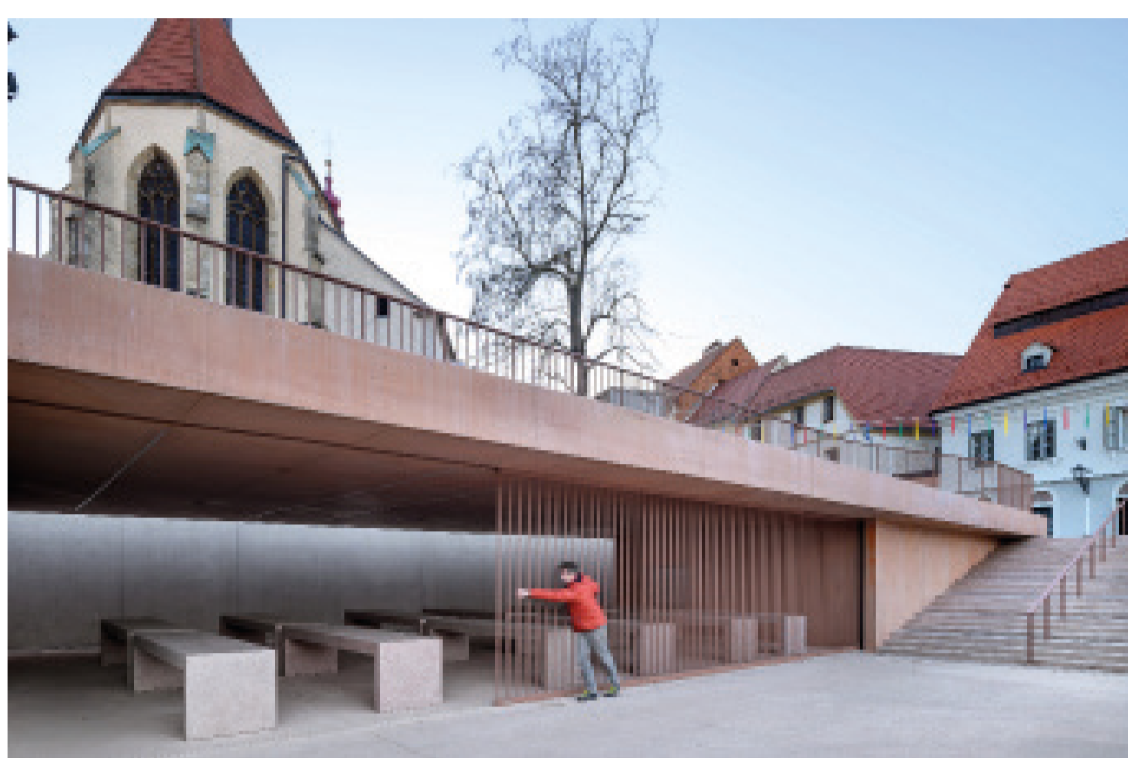
Levo in desno: Pokriti del tržnice je izveden iz rdečega betona, ki tonsko posnema opečnate strehe in se likovno poenoti z okolico. (vir: Arhitektura Krušec, foto Miran Kambič, 2021)
